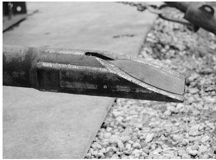
先端ヘッド。水圧でインナーピースが外れ、管内部を貫通させる
