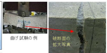
短繊維混合改良体の強度試験結果
