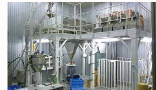
種子自動計量袋詰装置 一施工単位で品質保持材と一緒に種子を袋詰めしたレミディンズを出荷します。
