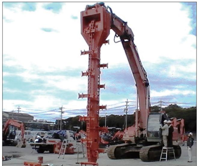
● パワーブレンダー施工機械(PBT-700) 全景
