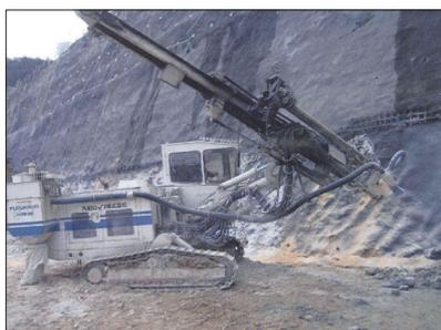
● 油圧式クローラドリルによる施工
