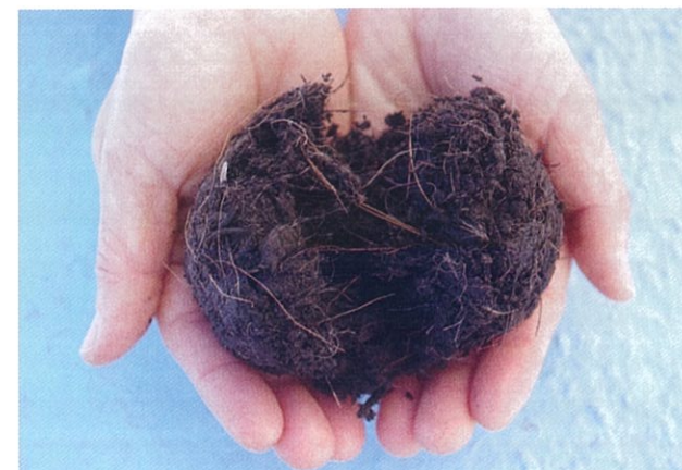
ノンラスファイバーが複雑に絡み合った植生基材
