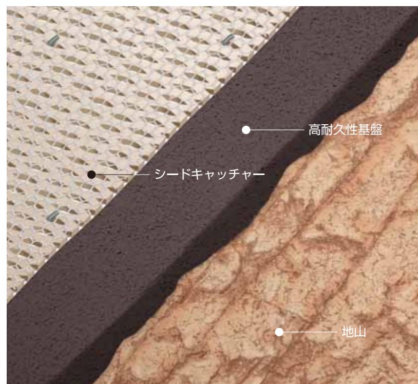
法面に高耐久性基盤を吹付け、その上にシードキャッチャーを張り付けるので、凸凹のある岩盤法面にも適用することができます。
