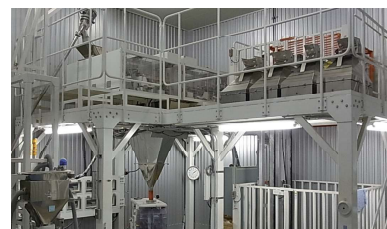
種子は、自動計量袋詰装置で一施工単位で計量し、品質保持材とともに専用種子小袋に袋詰めします。
