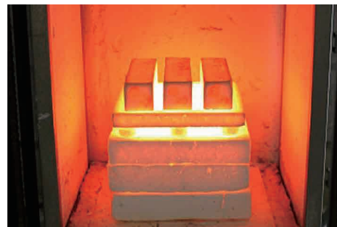
耐火材の耐熱試験状況
