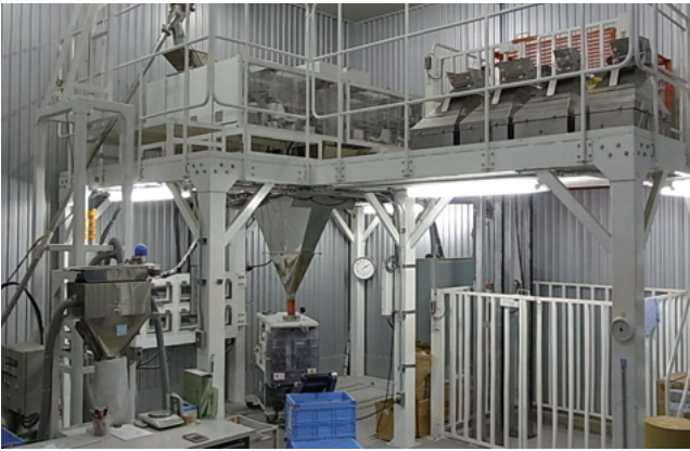
種子自動計量袋詰装置 種子と品質保持材を混ぜて袋詰めしたレミディシーズを出荷します。
