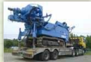
■ コンパクトな設計により施工深度20mを実現でき施工機を分解せず25tトレーラで運搬できます。(GI-130C-HT-KF)
