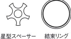
星型スペーサー 結束リング
