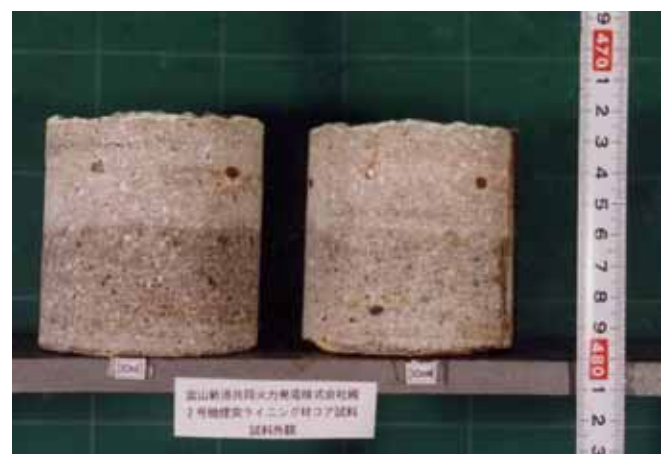
コアリングにより採取したサンプル
