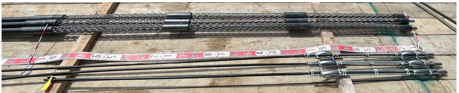
トメジローボルトの定着部（上：標準型、下：簡易型）
